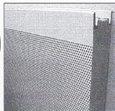
Cerramiento compuesto por paneles sándwich de chapa perforada por un lado, rellenos de lana de roca de 80 mm de espesor y 120 kg/m<sup>3</sup> de densidad. Dimensiones de la muestra: 3240 x 4000 mm.
